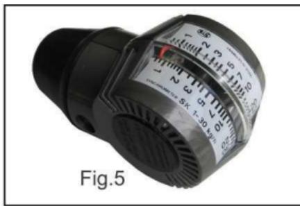
Éste instrumento nos brinda una precisión única al momento de sincronizar las diferentes mariposas de aceleración de cada carburador. Simplemente con ubicar su boquilla dentro de la trompeta del carburador (Fig.6) alcanza para que su aguja indique un valor de succión (presión negativa, comúnmente llamada 'vacío') que deja indicado en su escala. De esta manera simplemente desde el registro del tope de mariposa logramos que todos los carburadores estén en la misma sintonía.
